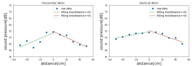
(a) 水平方向距離-音圧特性. (b) 垂直方向距離-音圧特性.
